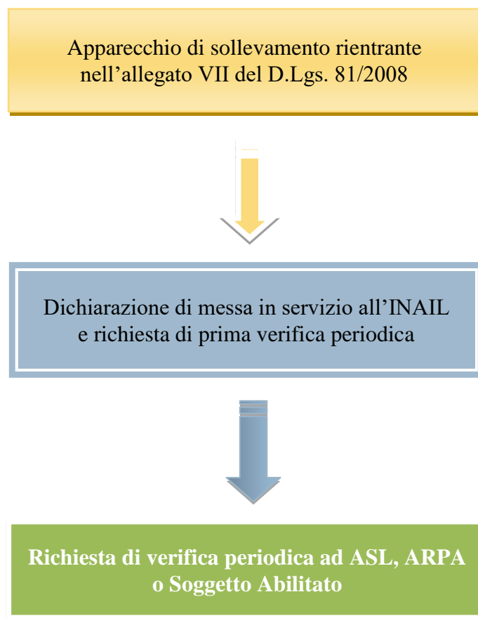
Figura 5. Schema procedura messa in servizio e verifiche periodiche di apparecchi di sollevamento.
