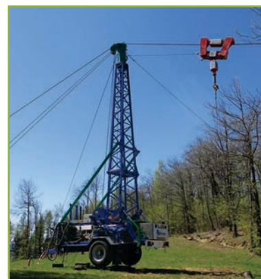
Gru a cavo con stazione mobile
