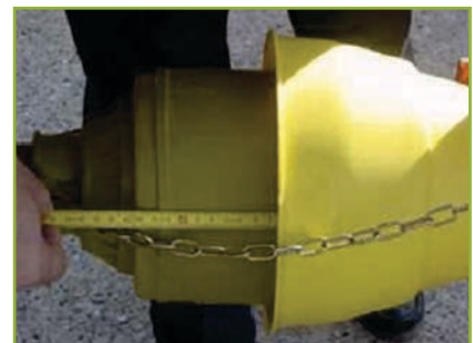
Esempi e schema di collegamento trattore-macchina operatrice, protezione albero cardanico
