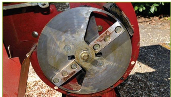
Disco e coltelli di una cippatrice a disco
