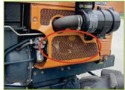
Elementi mobili correttamente protetti
