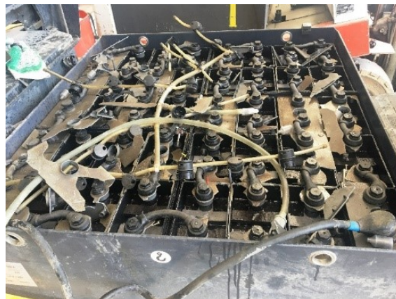
Batteria in ricarica dove si sviluppa gas idrogeno
