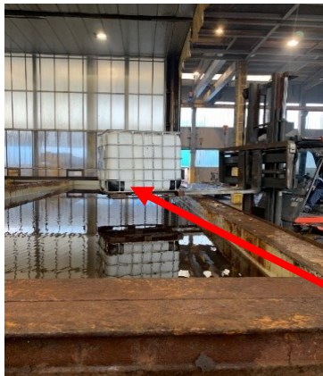
Foto 1 e 2: vasca di trattamento acido per decapaggio, cisternetta H 2 O 2 (acqua ossigenata) e impianto di aspirazione
