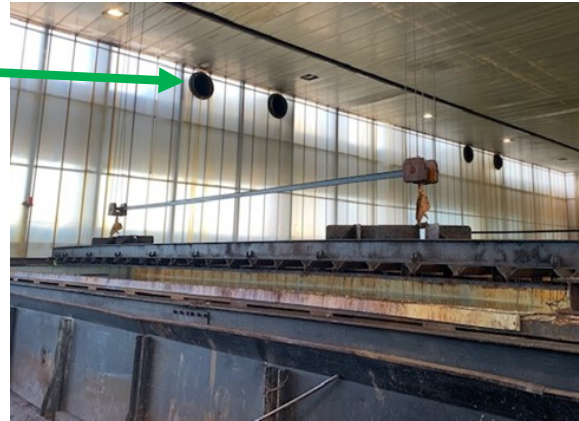
Foto 1 e 2: vasca di trattamento acido per decapaggio, cisternetta H 2 O 2 (acqua ossigenata) e impianto di aspirazione
