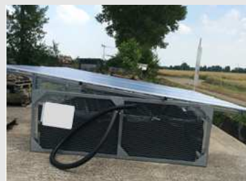
Sistema di decontaminazione delle acque di tipo fisico Heliosecc (foto F. Sormani)
