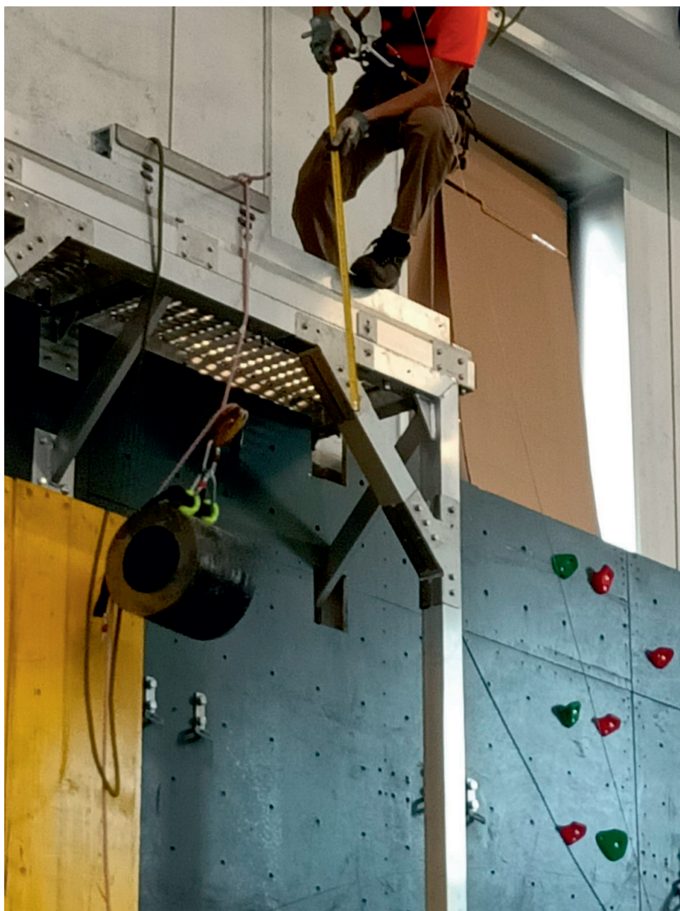
Figura 7.2.1-5 - Sistema di accesso su corda – Caduta dinamica – Fine prova
