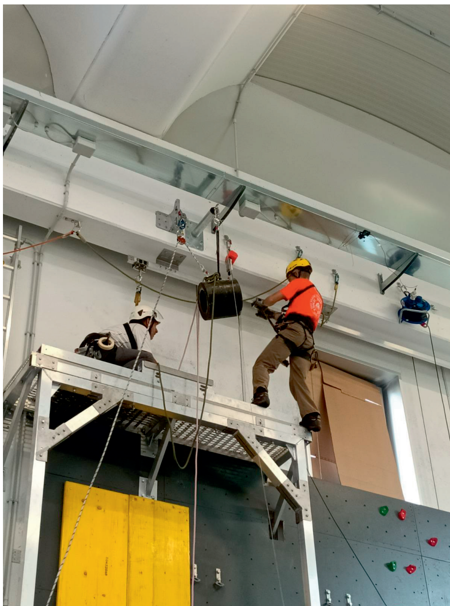
Figura 7.2.1-4 - Sistema di accesso su corda – Caduta dinamica – Inizio prova
