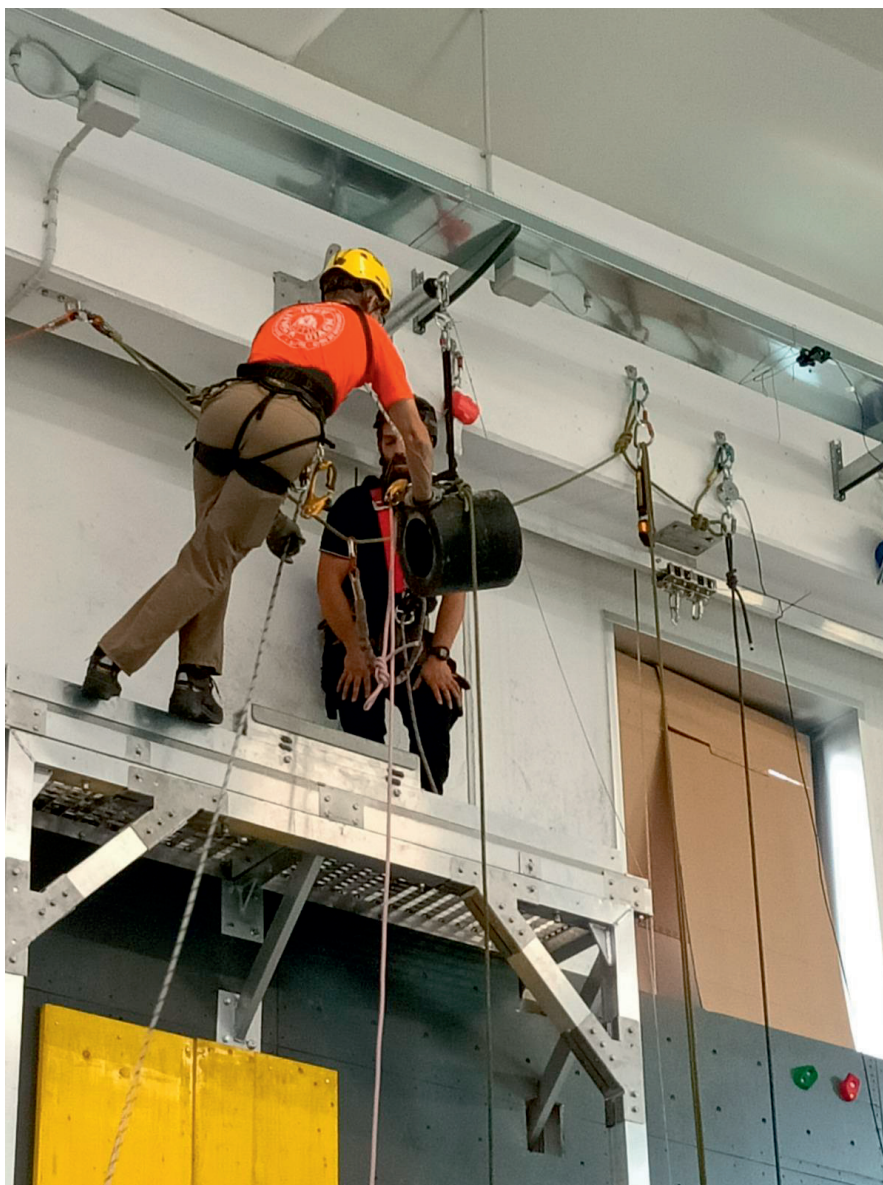
Figura 7.2.1-3 - Sistema di accesso su corda – Caduta dinamica – Innalzamento massa rigida
