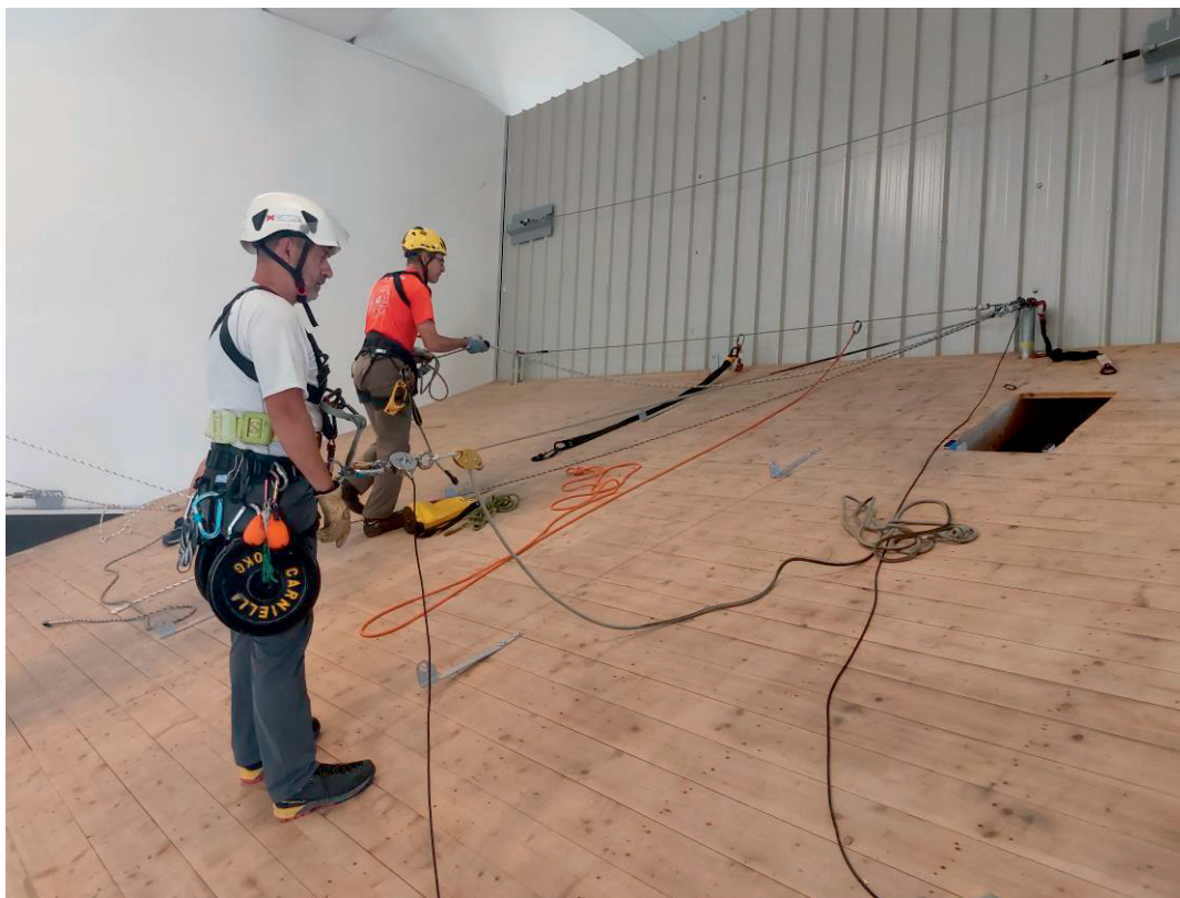
Figura 7.2.2.3-2 - Sistema di posizionamento sul lavoro e di salvataggio - Struttura di prova
