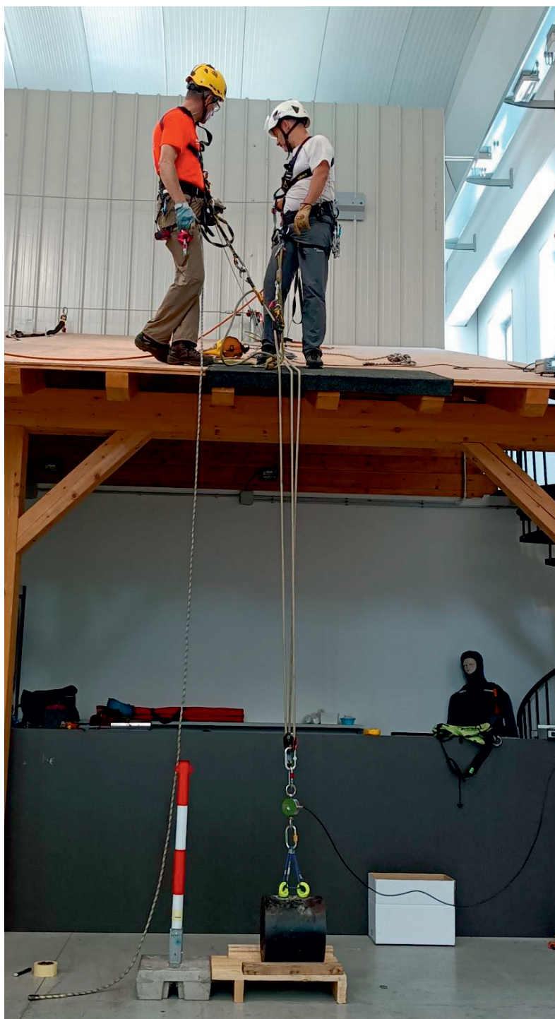
Figura 7.2.1-6 - Sistema di salvataggio - Salvataggio verso l'alto
