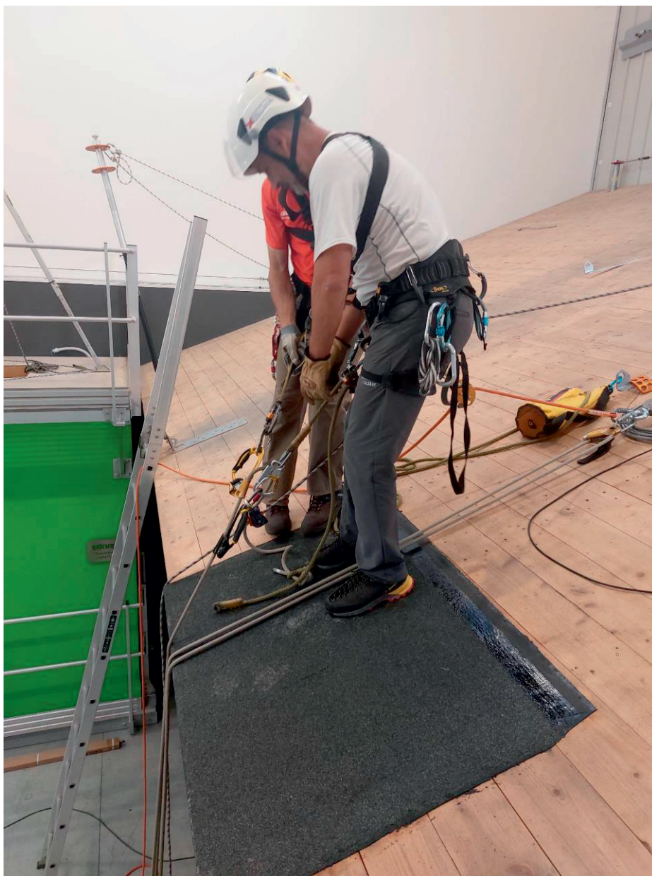
Figura 7.2.1-7 - Sistema di salvataggio - Salvataggio verso l'alto Condizione di 'attrito tre corde' - (Prova 6A.1)
