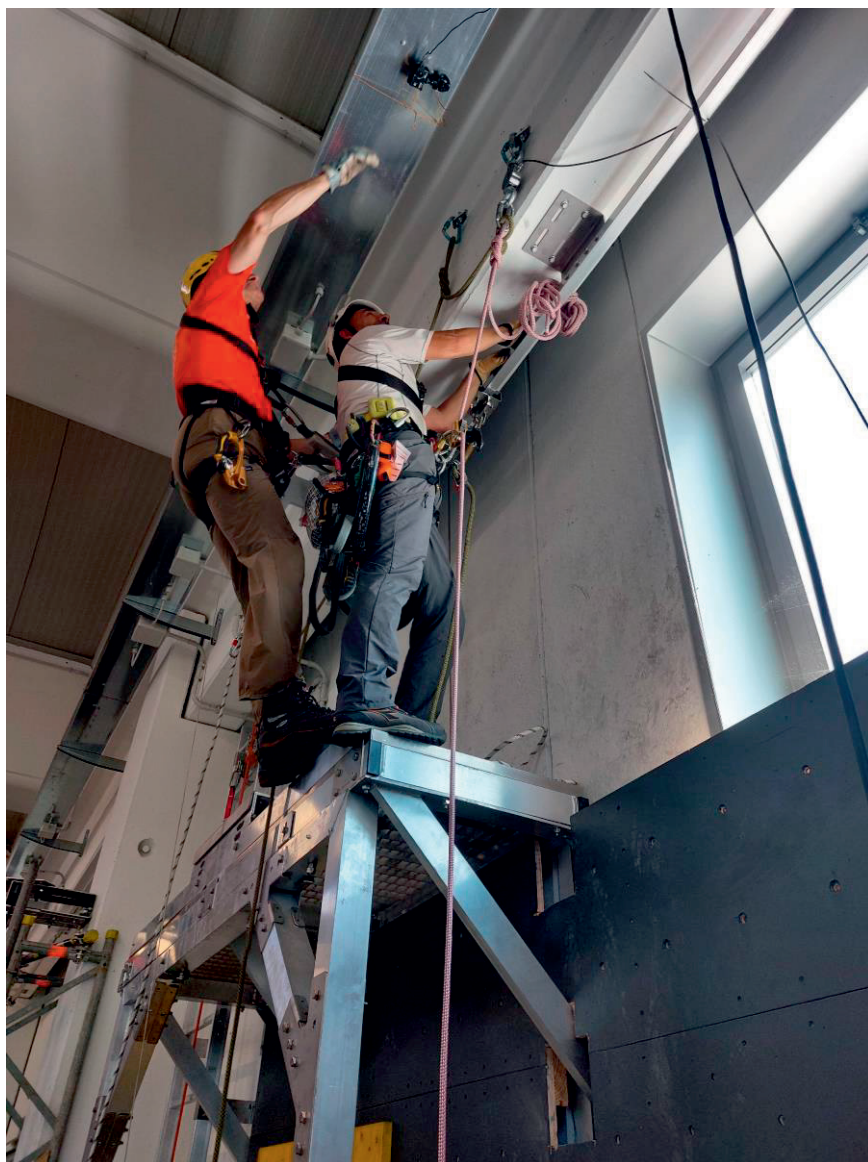
Figura 7.2.2.3-1 - Sistema di accesso su corda - Struttura di prova
