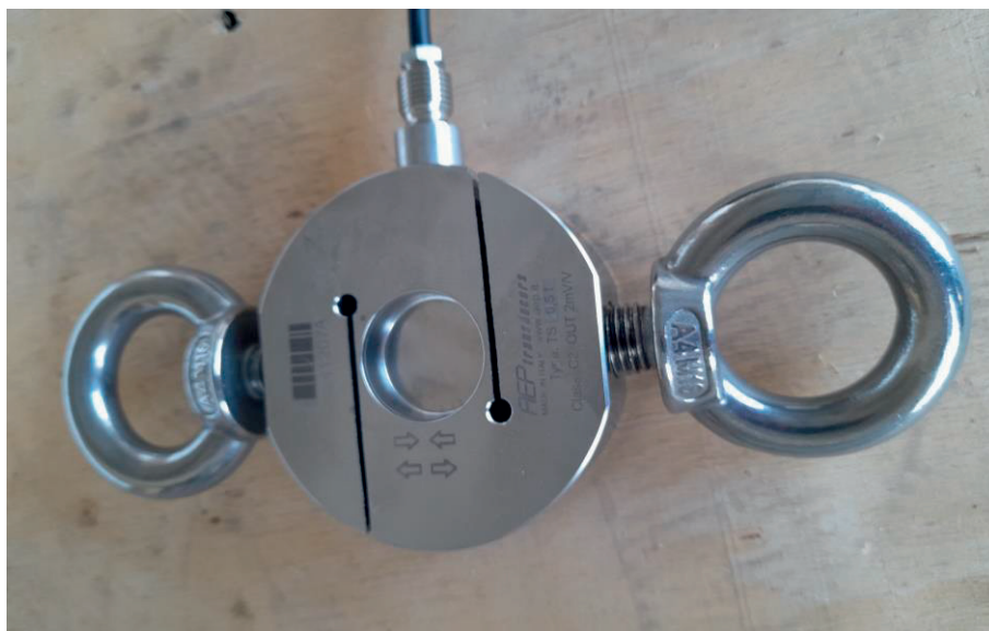
Figura 7.2.2.2-1 Cella di carico da 500 kg
