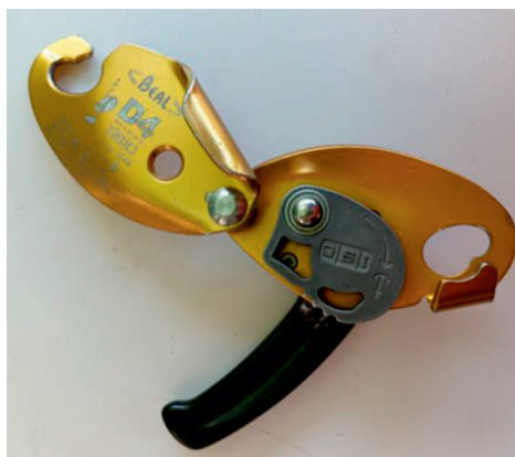
Figura 4.7-2 - Esempio di discensore a camma
