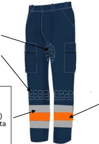
N 2 BANDE RETRORIFLETTENTI (che circondano completamente le gambe) di colore grigio chiaro rifrangente tipo microsfera, di altezza pari a 5 cm di cui una posta in corrispondenza del polpaccio l'altra posta ad almeno 5 cm sopra il bordo inferiore.
