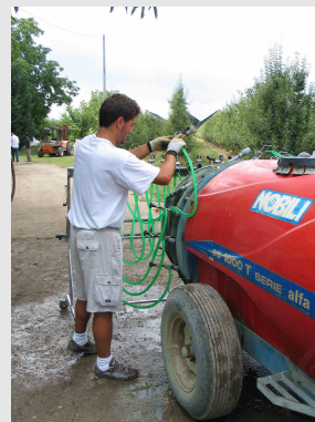
Operazione di taratura (Foto Cons. Fito. Reggio Emilia)
