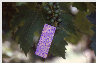
Cartine idrosensibili per rilevare la bagnatura durante i trattamenti (Foto Cons. Fito. Reggio Emilia)
