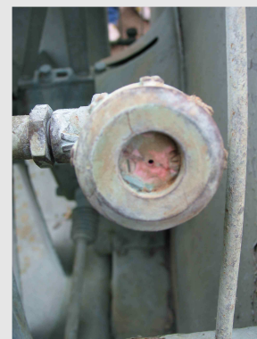
Ugello in eccessivo stato di usura (Foto Cons. Fito. Reggio Emilia)
