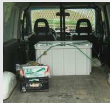
Contenitore adeguato a contenere i prodotti fitosanitari durante il trasporto (Foto tratta da: Linee guida per un uso sostenibile dei prodotti fitosanitari AA.VV.)
