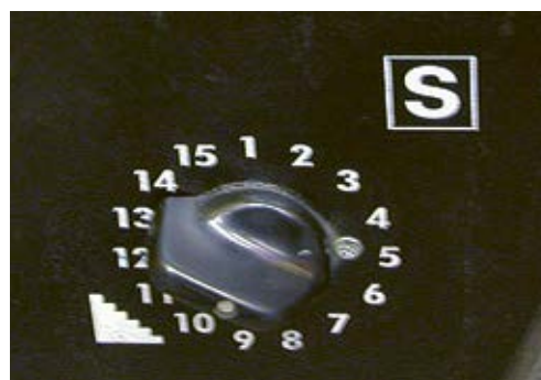
2 Lettera S apposta sulle sorgenti di saldatura per i lavori con un elevato rischio elettrico
