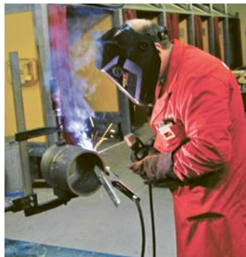
1 Prima di iniziare a lavorare il saldatore deve accertarsi che il cavo di massa sia collegato correttamente.
