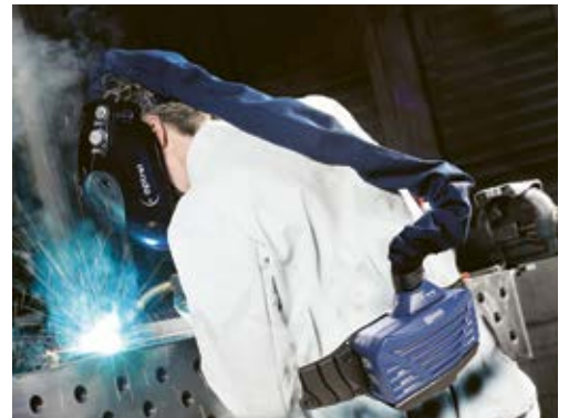
5 Quando si effettua la saldatura manuale ad arco o il taglio al plasma su pezzi legati in ambienti scarsamente ventilati occorre indossare un casco con sistema di ventilazione assistita.
