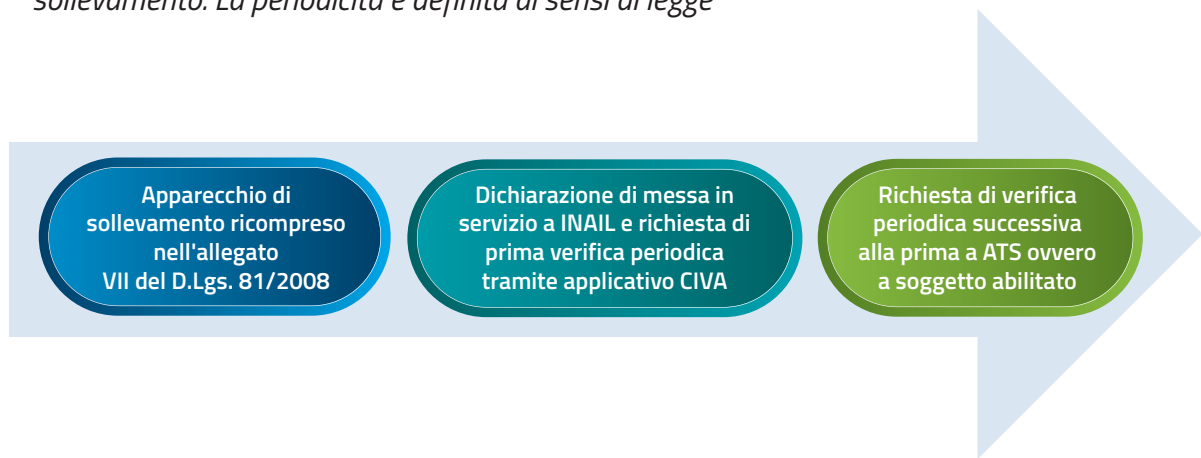
Figura 3. Schema procedura messa in servizio e verifiche periodiche di apparecchi di sollevamento. La periodicità è definita ai sensi di legge
