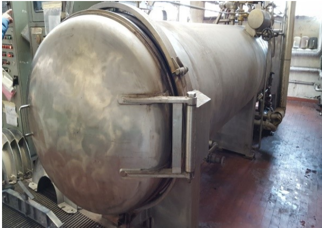
Foto 1 e 2: impianto tintura tessuti a “siluri”
