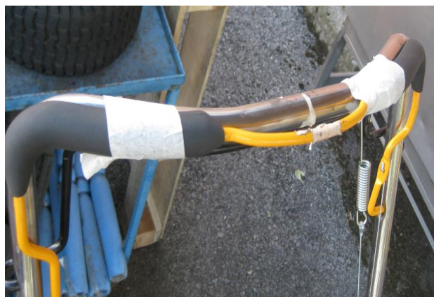
Foto 2: nastro bloccante la leva di fermo del "motorstop"
