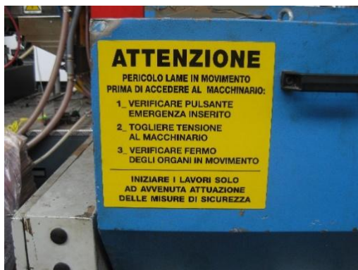
Foto 3: Segnalazione di pericolo lame in movimento e istruzioni operative
