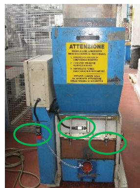
Foto 4: Mulino granulatore dotato di microinterruptori supplementari e dadi di blocco ai tiranti
