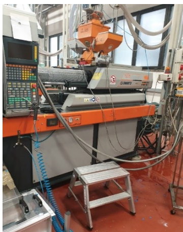
Foto 1: pressa iniezione materie plastiche con tramoggia da pulire e sistema inadeguato di accesso in quota
