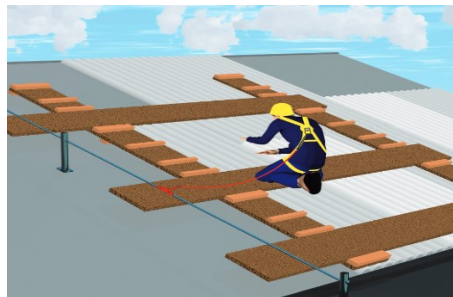
Foto 4: esempio di utilizzo di DPI contro le cadute dall'alto e predisposizione di camminamenti su coperture non pedonabili
