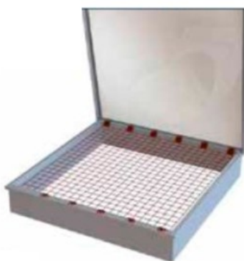
Foto 5: esempio reti metalliche permanenti contro il rischio di caduta
