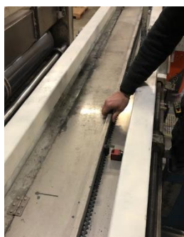
Immagini 5, 6 e 6: esempio di protezione del calamaio. A sinistra, lo sportello incernierato completamente chiuso. Al centro, lo sportello incernierato aperto, mostra la griglia di protezione sottostante in acciaio forato, che consente la visibilità e la possibilità di aggiungere acqua al calamaio senza entrare a contatto con esso. La griglia è protetta da microinterruttore a forchetta. A destra i rulli pericolosi sottostanti del calamaio di stampa.
