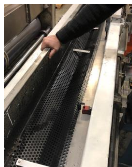
Immagini 5, 6 e 6: esempio di protezione del calamaio. A sinistra, lo sportello incernierato completamente chiuso. Al centro, lo sportello incernierato aperto, mostra la griglia di protezione sottostante in acciaio forato, che consente la visibilità e la possibilità di aggiungere acqua al calamaio senza entrare a contatto con esso. La griglia è protetta da microinterruttore a forchetta. A destra i rulli pericolosi sottostanti del calamaio di stampa.
