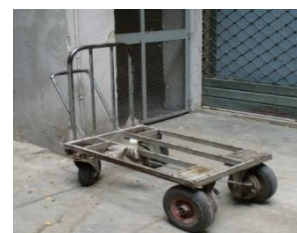
Carrellino dotato di freni a tamburo sulle due ruote anteriori manuale idonea allo scopo
