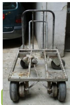
Carrellino dotato di freni a tamburo sulle due ruote anteriori manuale idonea allo scopo
