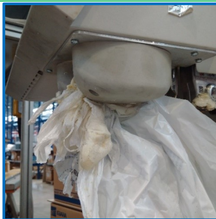
Foto 2: dettaglio punto di inceppamento
