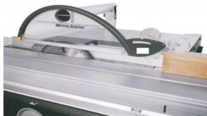
Foto 2: Sega circolare squadratrice con protezione sospesa
