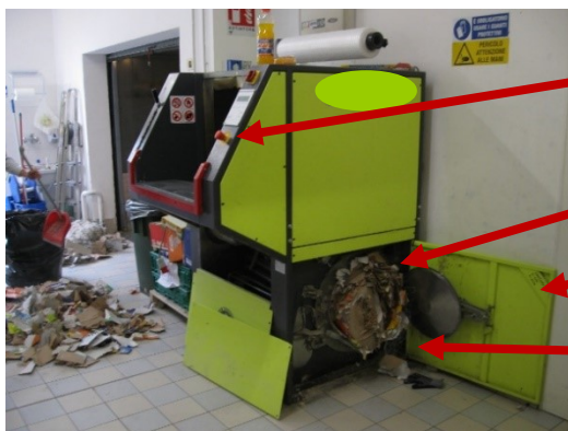
Foto 1: macchina compattatrice cartoni
