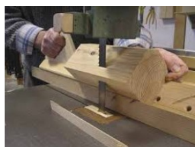
Foto 4: Esempio di spingitoio per sega a nastro
