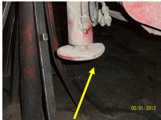
base deformata stabilizzatore idraulico sponda
