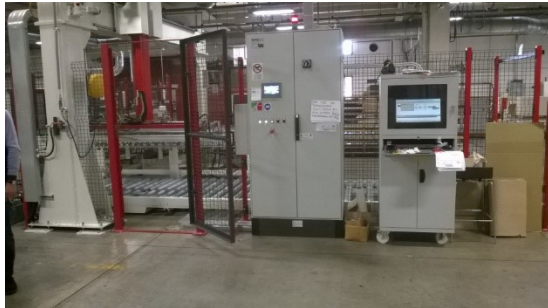
Foto 1: impianto di movimentazione di carico pannelli in legno per la linea di foratura
