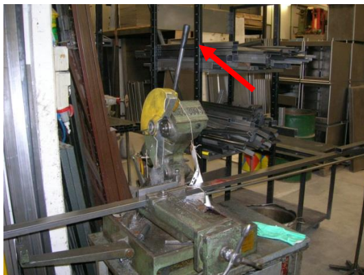
Foto 1: Troncatrice senza pulsante di avviamento ad "azione mantenuta" sull'impugnatura di comando
