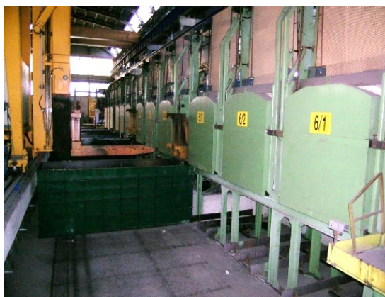
Foto 2: impianto con forni, magazzini, e vasche in "fossa"
