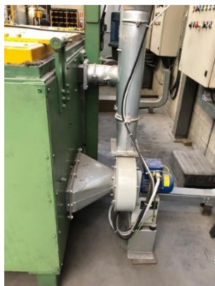
Foto 5: sistema di controllo aspirazione
