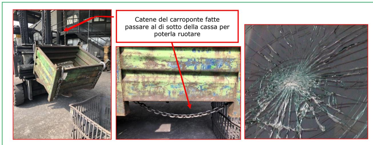
**Tipo di Incidente:** Proiezione di solidi / Oscillazione incontrollata della catena del carro ponte, con proiezione del gancio
