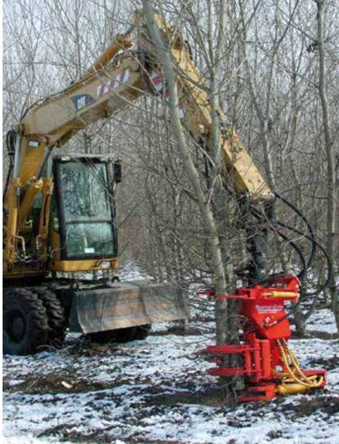
Fig. 8 - abbattitrice a cesoia e particolare della testata
