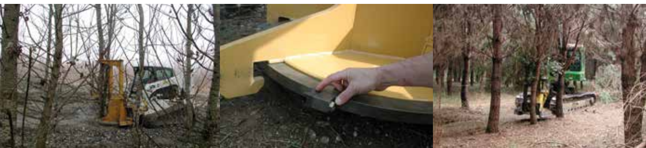
Fig. 7- abbattitrice a disco e particolare del disco di un modello compatto splay di un computer di bordo dell'harvester
