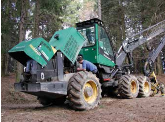
Fig. 13 - manutenzione eseguita con il motore spento, la testata a terra e le strutture tenute alzate da appositi sostegni
