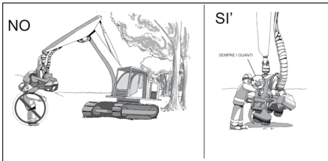
Fig. 29 - esempio pericoloso di manutenzione (a sinistra) e procedura corretta (a destra)
