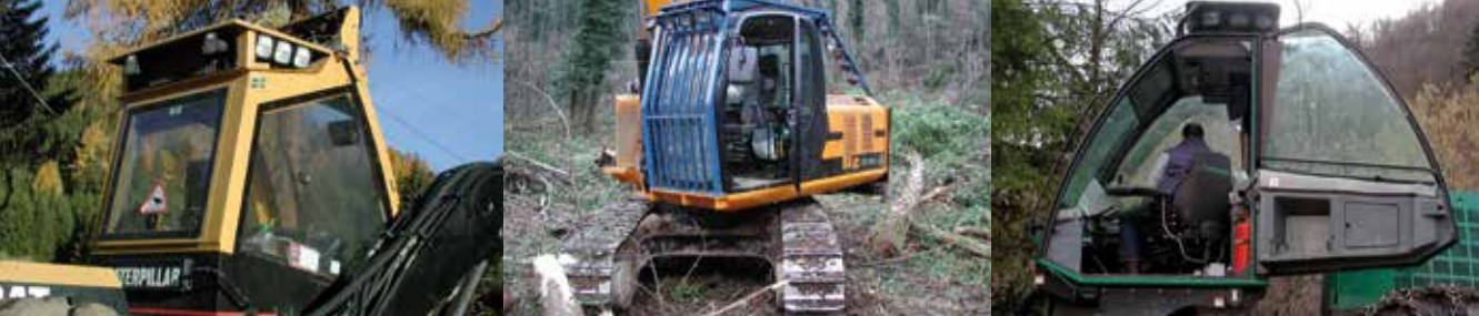
Fig. 12- cabine con strutture OPS, ROPS e FOPS
