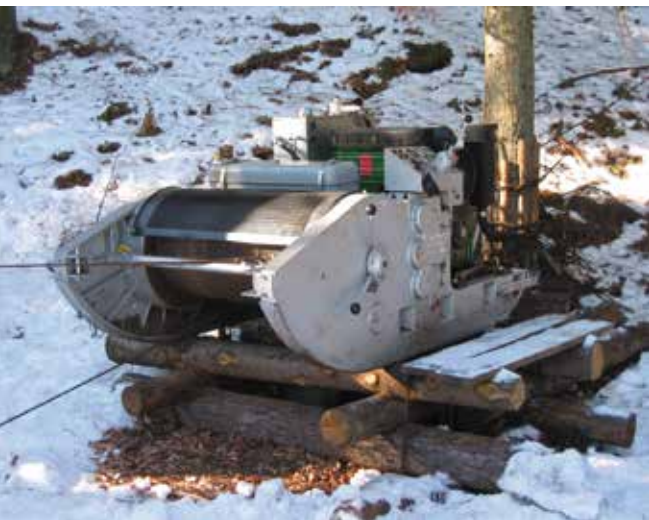
Fig. 1 - Argano tradizionale su telaio a slitta
