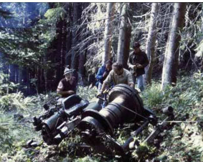
Fig. 2 - Autoissaggio dell'argano
