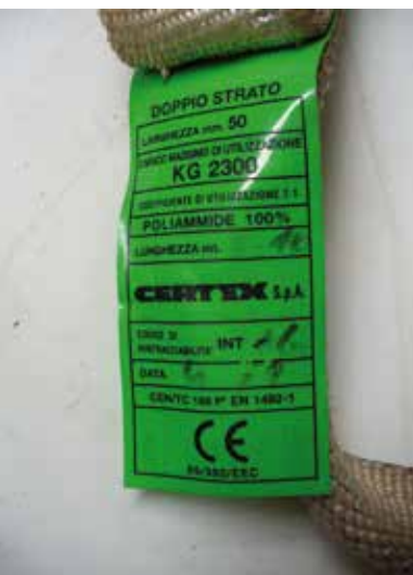
Fig. 26 - Designazione della portata di brache
