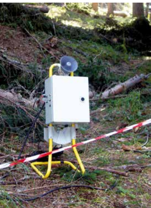
Fig. 22 - Impianto di comunicazione ad altoparlante
