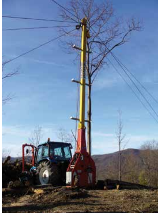
Fig. 3 - Gru a cavo a stazione motrice mobile per trattore
