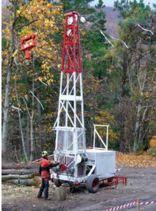
Fig. 4 - Gru a cavo a stazione motrice mobile su rimorchio
