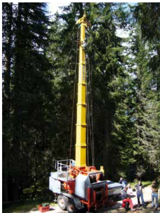
Fig. 16 - Argano a stazione motrice mobile su rimorchio
