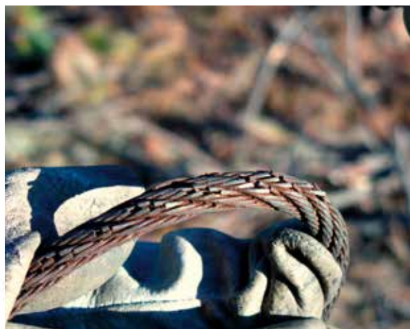
Fig. 14 - Fune con un considerevole numero di fili rotti
