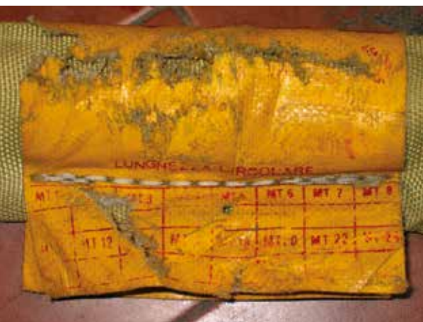
Fig. 27 - Danneggiamenti di brache tali da metterle fuori servizio
