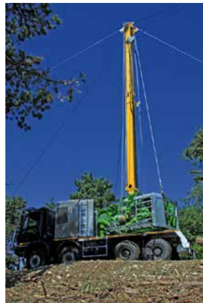
Fig. 5 - Gru a cavo a stazione motrice mobile su autocarro
