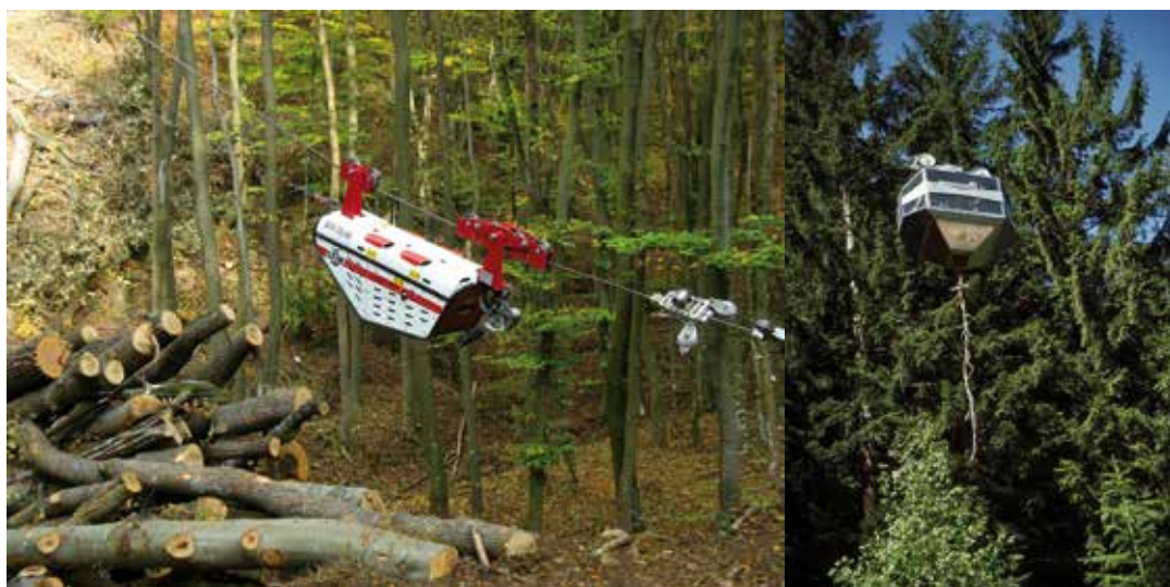
Fig. 20 - Carrelli motorizzati
