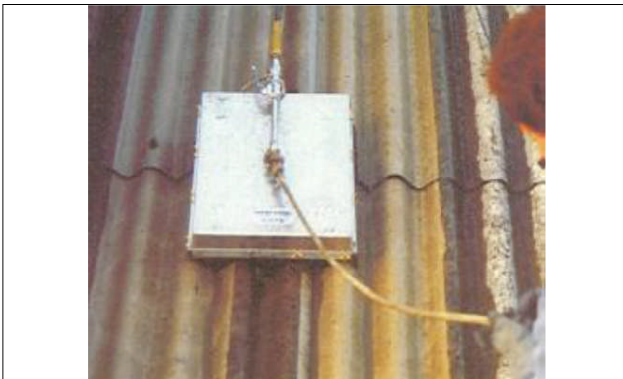
Fig. 03 - Particolare del pulitore mobile a getto d'acqua ad alta pressione
