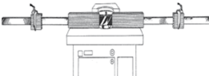
Esempio di BATTUTE di INIZIO e FINE PASSATA applicate alle guide longitudinali (direttamente o, per la fresatura di pezzi di grande lunghezza, su apposite prolunghe delle guide)
