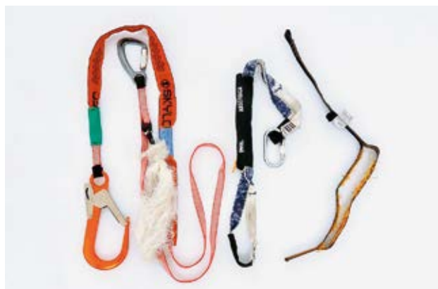
Figura 11 Esempi di ammortizzatori di caduta strappati. Lo strappo attutisce il contraccolpo.
