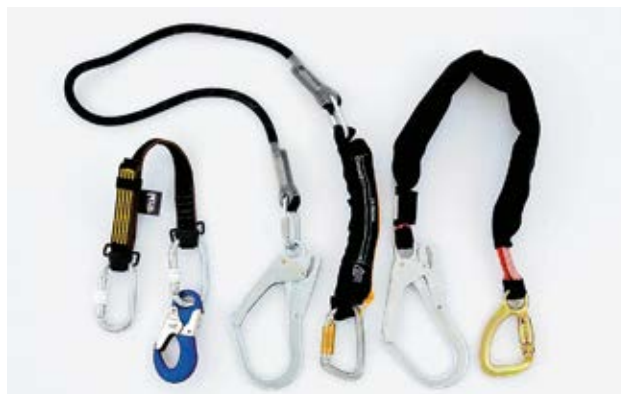
Figura 10 Nastro a strappo, integrato come assorbitore di energia in un cordino di posizionamento. Con un carico di circa 3 \text{ kN} ( 300 \text{ kg} ) il nastro inizia a strapparsi.
