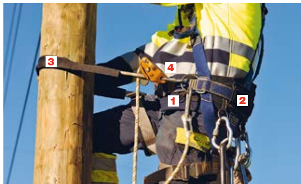
Figura 5 Cintura per salire sui piloni con fune di posizionamento e dispositivo di regolazione della lunghezza. Il dispositivo di regolazione della lunghezza consente di adattare la lunghezza della fune di posizionamento.
