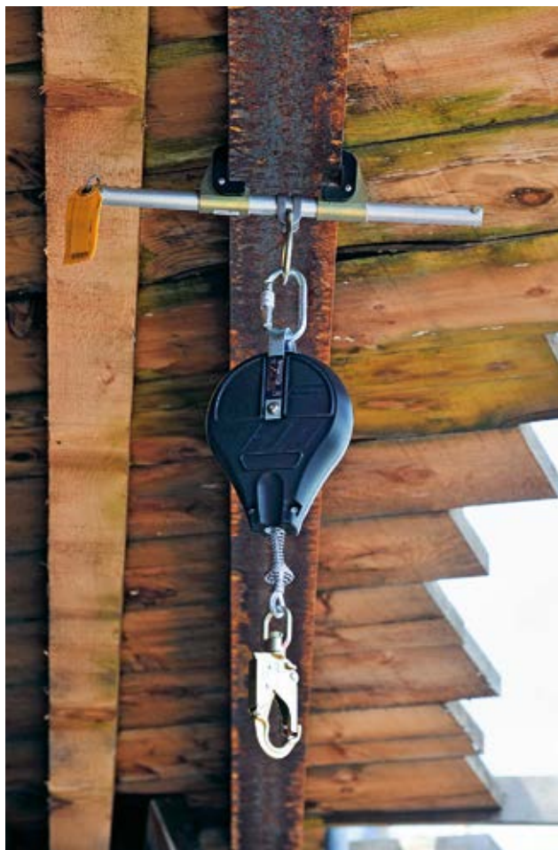
Figura 22 Dispositivo anticaduta di tipo retrattile montato su un punto di ancoraggio mobile.
