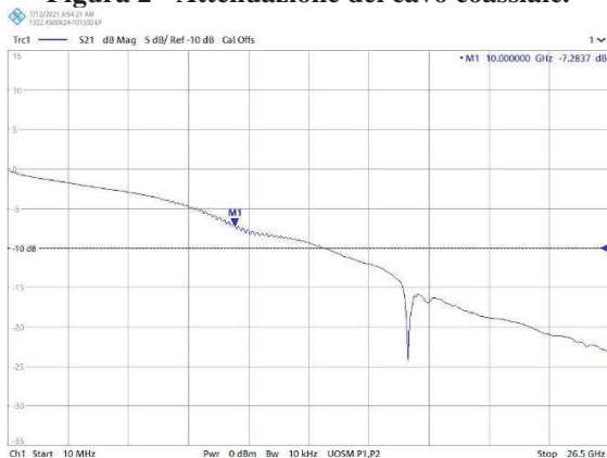
Figura 2 - Attenuazione del cavo coassiale.
