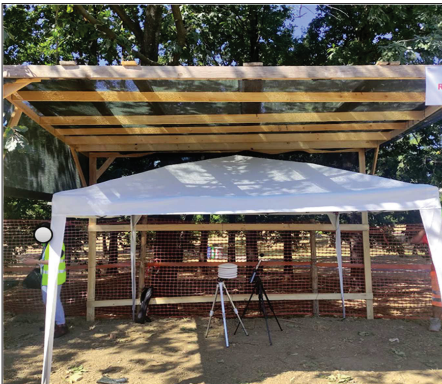
Foto 3: sistema ombreggiante composto da due coperture per aumentare la protezione dalla radiazione solare
