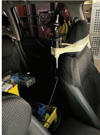
Figura 1. Postazione di misura fonometrica nella posizione di guida dell'ASI.
