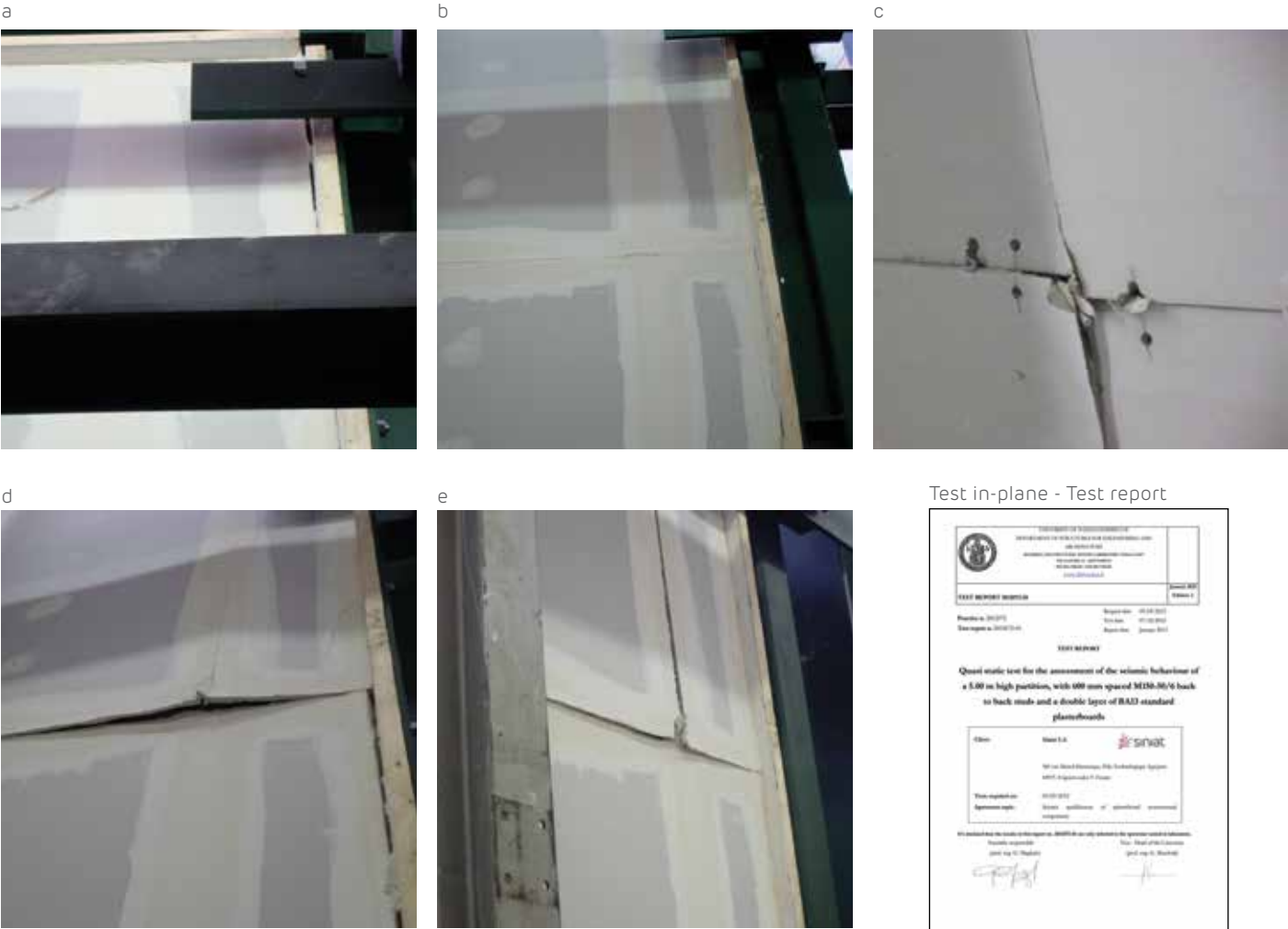
Test in-plane - Progressione del danneggiamento
