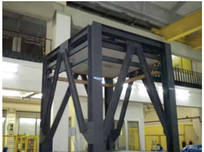
Test su tavola vibrante - Test report controsoffitti
