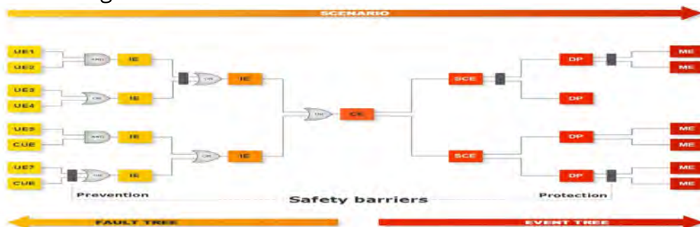
Figura 2. Uno scenario illustrato in un diagramma "Bow-tie"
