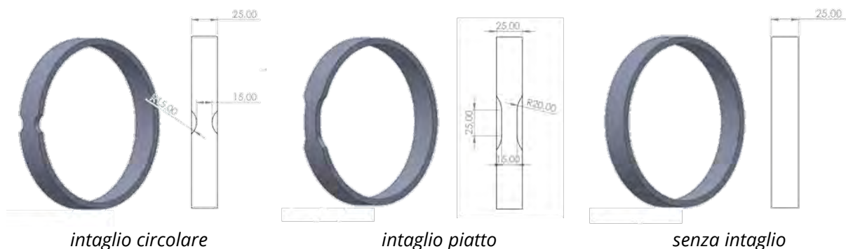
Figura 4. Tipologia di provini oggetto delle prove sperimentali.
