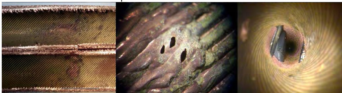
Figura 2. Foratura per sovravelocità in tubi in rame di condensatore di gruppo frigorifero. Si noti come la presenza del frammento di materiale plastico (proveniente da torre evaporativa) bloccato nella spirale del tubo è stato la causa della problematica
