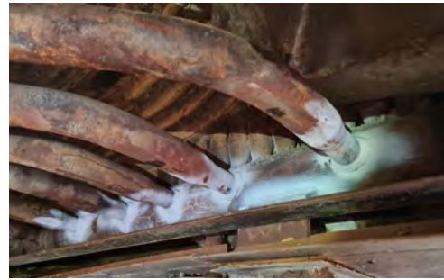
Figura 8. Esempio di CND sulle connessioni tubo-collettore
