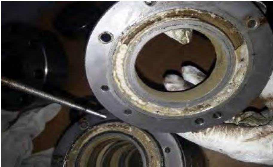
Figura 7. Scatola premistoppa, presenza di calcare nel canale di passaggio dell'acqua di raffreddamento.
