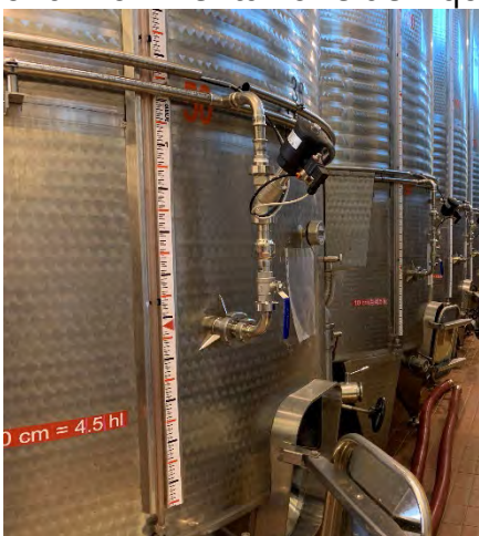
Figura 4. Sistema a getti di aria modulati
