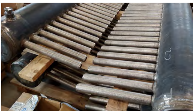
Figura 1. Tubi rivestiti in Inconel 625
