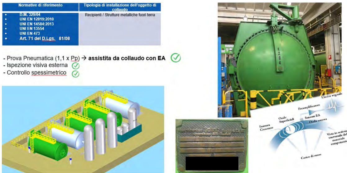
Figura 2. Progettazione del test con metodo dell'emissione acustica EA eseguito su un'autoclave
