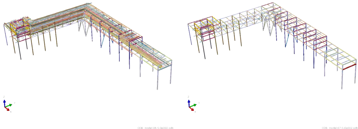
Figura 3-2 (a sinistra) Modello FP (frame + piping) – (a destra) Modello F (tradizionale, solo frame)
