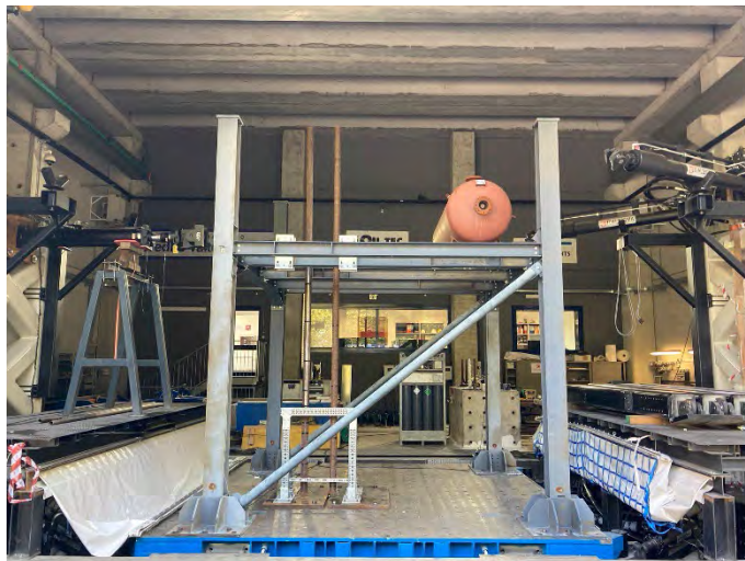
Figura 8. Test su tavola vibrante
