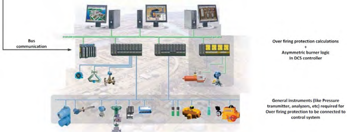
Figura 4. Architettura del sistema di controllo generale OFF-TFM
