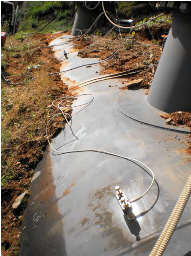
Figura 1. Controllo attraverso le Emissioni Acustiche
