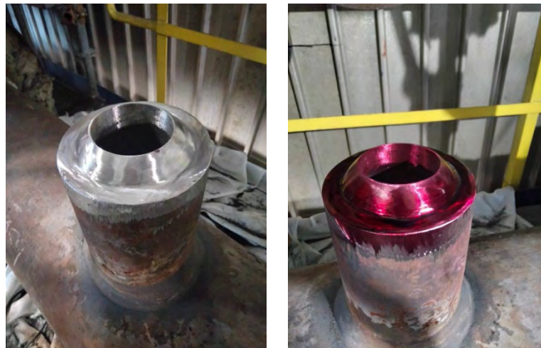
Figura 2. Realizzazione del cianfrino e sua verifica ai liquidi penetranti
