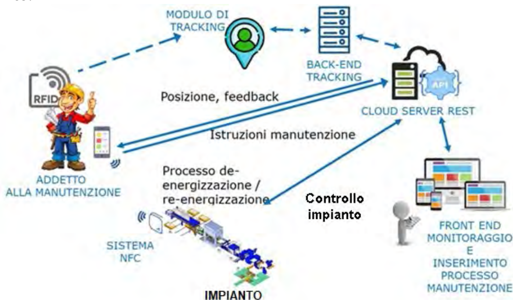
Figura 2. Sistema smart per la de-energizzazione di un impianto
