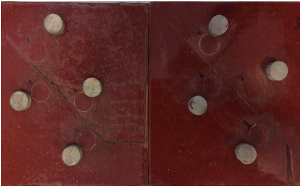
Figura 9. Test di adesione ISO4624 su campioni in acciaio carbonio rivestiti in HR60TL a 200 micron per simulare il ciclo impiegato nel rivestimento di scambiatori di calore. Condizionamento a 2000 ore mediante nebbia salina. Si osservi la non propagazione della corrosione a partire dall'intaglio ed il distacco adesivo del funghetto dal rivestimento a carichi elevati.
