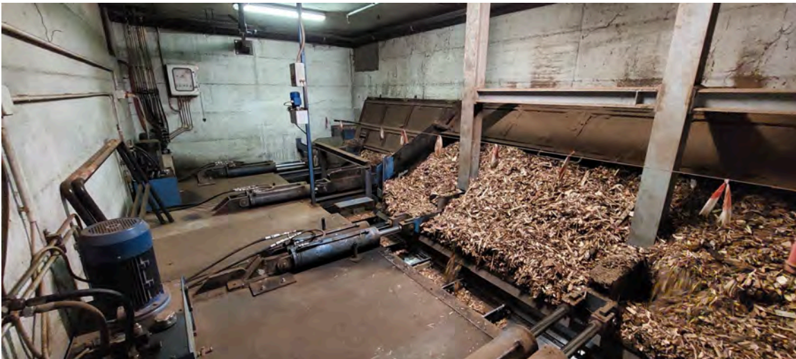
Figura 3. Estrazione dal silos e caricamento nastro trasportatore
