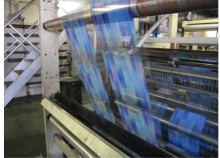
**Assenza barra antistatica prevista dal manuale della macchina: elevato campo elettrostatico IN PROSSIMITA' ROTOLI PLASTICA. RISCHIO innesco di incendi - RISCHIO PER PORTATORI PACEMAKER E DISPOSITIVI IMPIANTATI**
