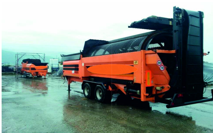
Figura 38: Vagliatore a tamburo rotante (trommel); vedi Riferimenti alle immagini
