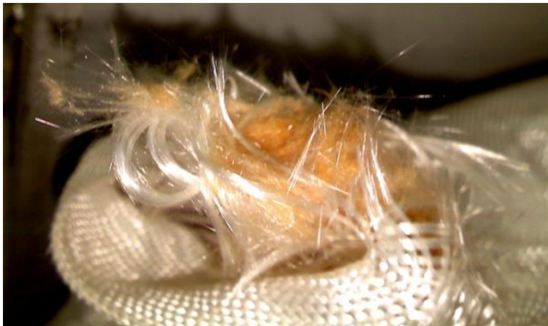
Figura 3 – Cordino isolante in fibra di amianto
