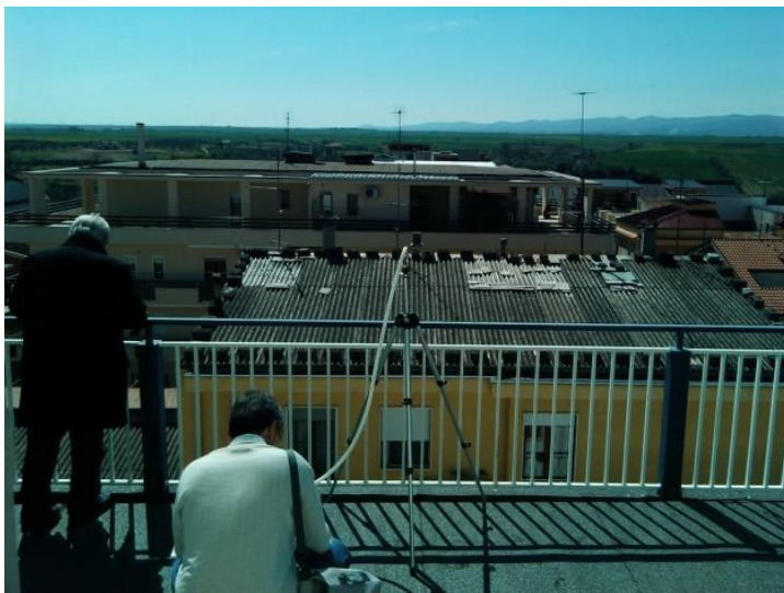
Figura 5 – Campionamento esterno d fibre aerdisperse
