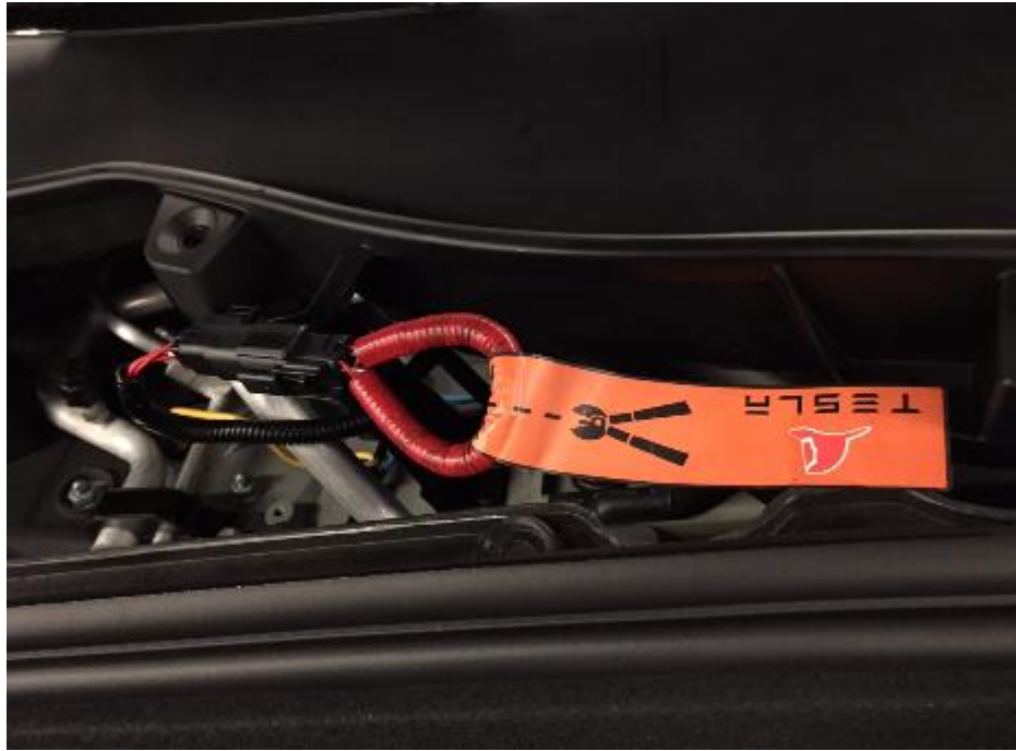
Tesla Model S. Il punto a sinistra nel cofano anteriore dove occorre tagliare il cavo con una pinza per interrompere l'alimentazione elettrica (a 12 V).
