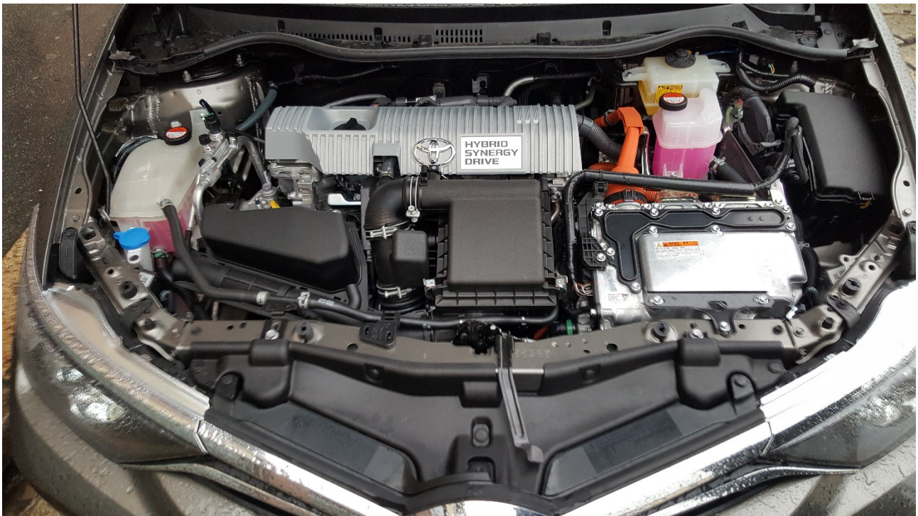
Toyota Auris ibrida modello 2016. Anche se mancasse la targhetta sul motore, i cavi arancioni ci dicono che siamo di fronte ad un veicolo elettrico con cavi ad alta tensione.
