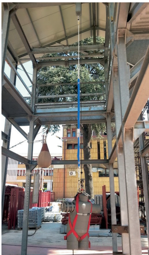
Figura 4.2.1-9 Posizione finale (Fase 4 - si noti l'assorbitore svolto)
