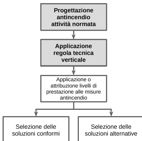
Illustrazione G 2.3: Progettazione antincendio delle attività normate
