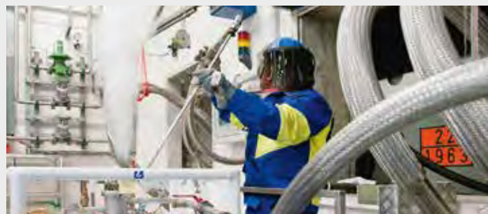
Travaso di elio liquido (-269°C) in impianto di riempimento gas speciali.
