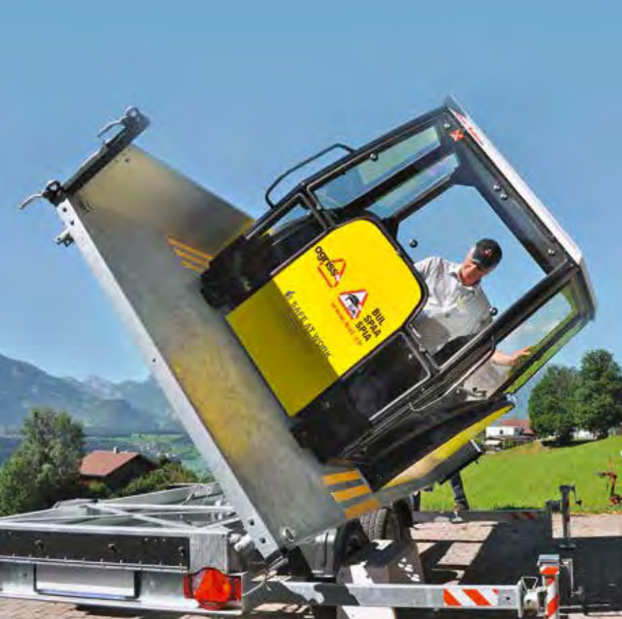
Il simulatore di rovesciamento per trattori evidenzia quali forze agiscono sul corpo in caso di ribaltamento del mezzo.
