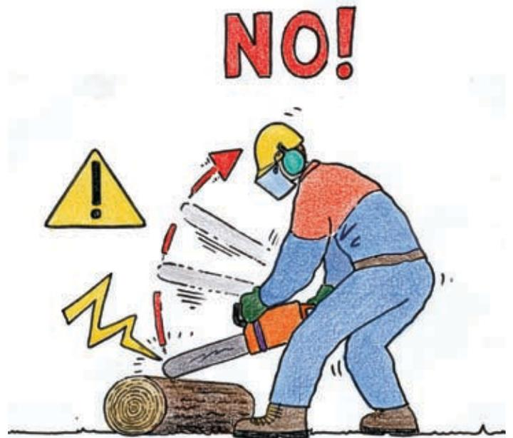
Inizia il taglio con il motore a piena potenza, piantando bene l'artiglio; quando estrae la motosega dal legno non completamente segato mantiene la catena in movimento.
