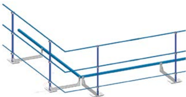
Fig. 5 Parapetto senza perforazione del manto di copertura, stabilizzato alla struttura portante dell'impianto fotovoltaico
