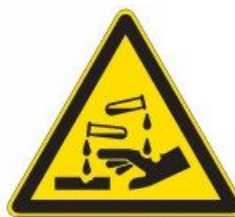
Pericolo sostanze corrosive W023 ●
