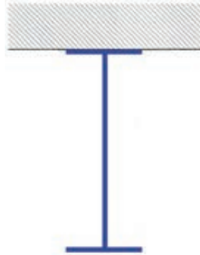
SEZIONE DI UN PROFILATO IN ALLUMINIO
