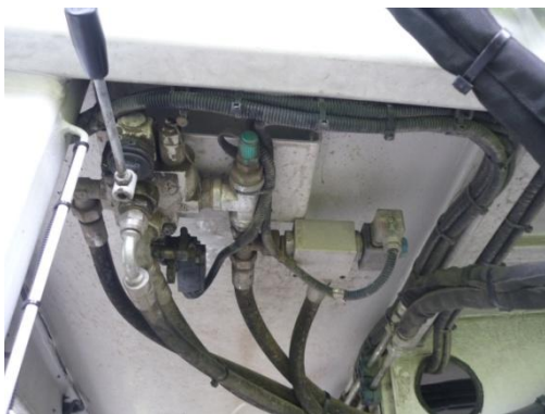
Sostituzione elettro-valvola difettosa ad azionamento manuale e verifica del suo funzionamento
