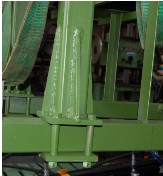
Figura 7. Dispositivo di attacco posteriore lato destro.
