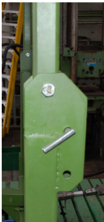
Figura 7. Snodo centrale del telaio anteriore (lato Sx).
