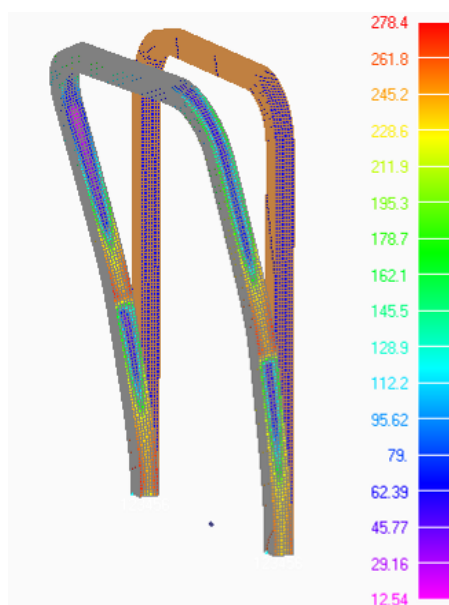
Figura 8. Carico posteriore: diagramma a falsi colori della tensione [MPa]
