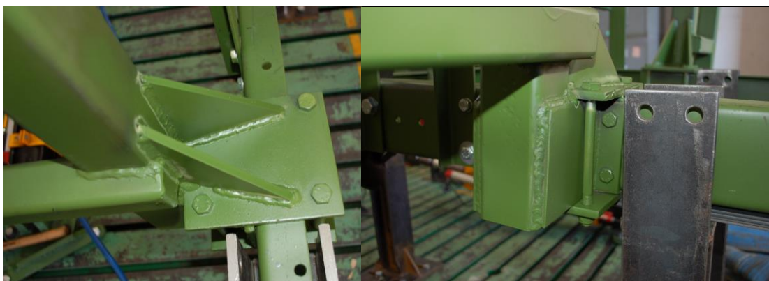
Figura 8. Dispositivo di attacco posteriore lato sinistro.
