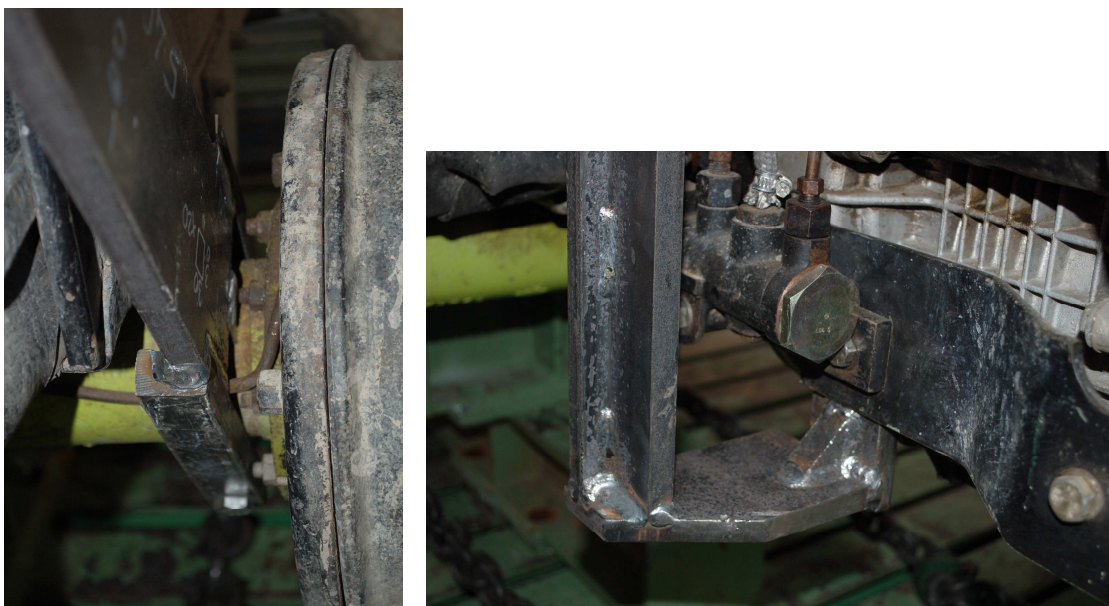
Figura 7. Collegamento del dispositivo di attacco lato sinistro alla motoagricola: collegamento al mozzo (a sinistra) e collegamento al motore (a destra).
