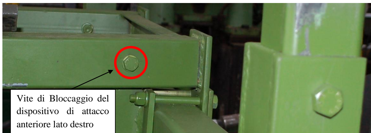
Figura 10. Dettagli relativi al bloccaggio del dispositivo di attacco anteriore.
