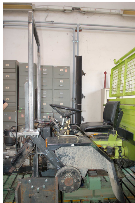
Figura 1. Struttura di protezione in caso di capovolgimento a due montanti anteriori per motoagricola Grillo 33 e simili. Componenti principali ed immagine del prototipo.
