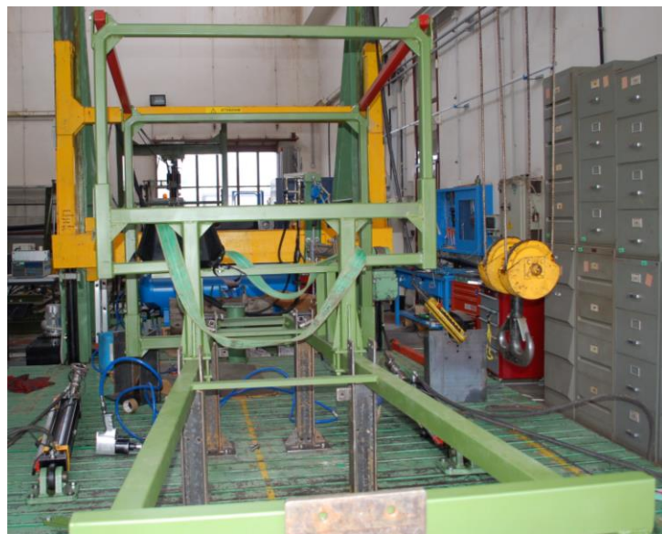
Figura 11. Configurazione della struttura ROPS con traverse longitudinali di collegamento.
