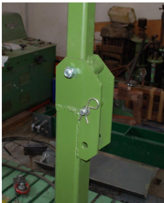
Figura 6. Snodo centrale del telaio anteriore (lato Sx).
