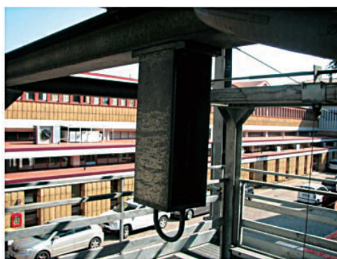
Figura 6.1.5 – Attrezzatura di prova - particolare del punto di ancoraggio fisso
