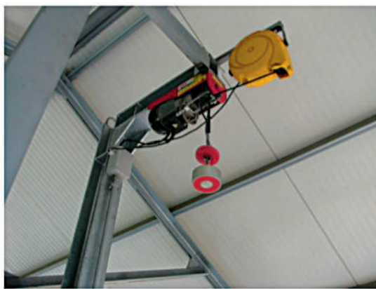
Figura 6.1.7 – Attrezzatura di prova - particolare del sistema di sollevamento e sgancio di tipo elettromagnetico
