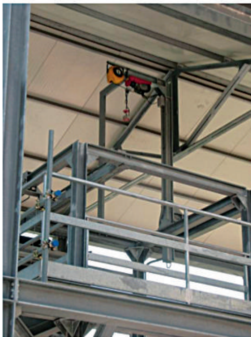
Figura 6.1.6 – Attrezzatura di prova - particolare del sistema di sollevamento e sgancio di tipo elettromagnetico
