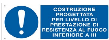
Illustrazione S.9-1: Esempio di segnale per livello di prestazione di resistenza al fuoco inferiore a III
